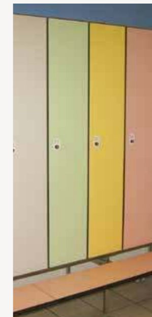
Variante mit vorgelagerter Sitzbank aus HPL-Kompaktplatten 13 mm, an der Vorderkante auf 26 mm aufgedoppelt und rundgefräst
