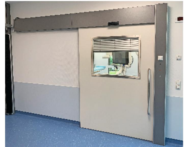
Schiebetüranlagen können mit HPL-Formteil- oder Edelstahlaufassungszarge ausgeführt werden. Türblattkern mit beidseitig 3 mm-starker HPL-Kompaktplatte. Durchblickfenster (Verglasungen) mit Strahlen- und Laserschutzanforderungen sowie Rollos oder Jalousien realisierbar. Laufwerkkästen mit Revisionsklappe und Zwischendeckenblende.
